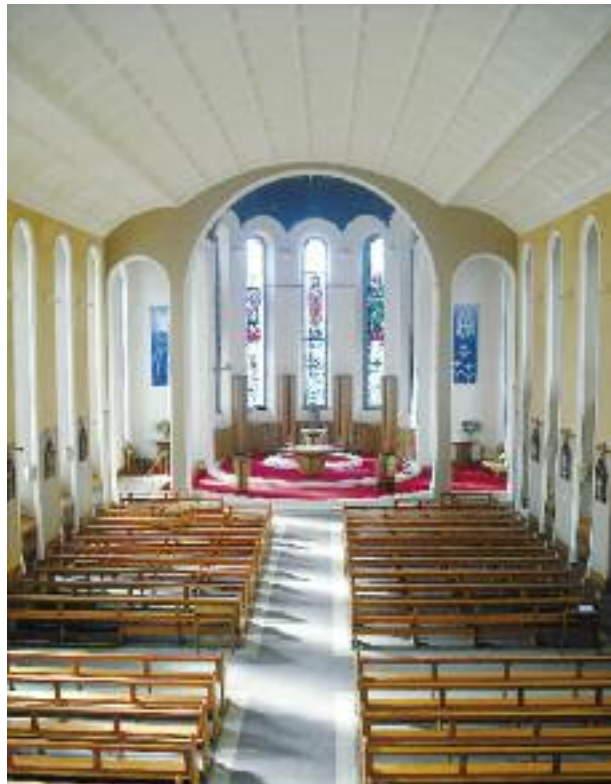
2 In der Kirche »Our Lady and St. Joseph« in Kildare wurde auf einer Fläche von über 300 m 2 die »Toptec« Akustikputzsystemplatte A installiert.
