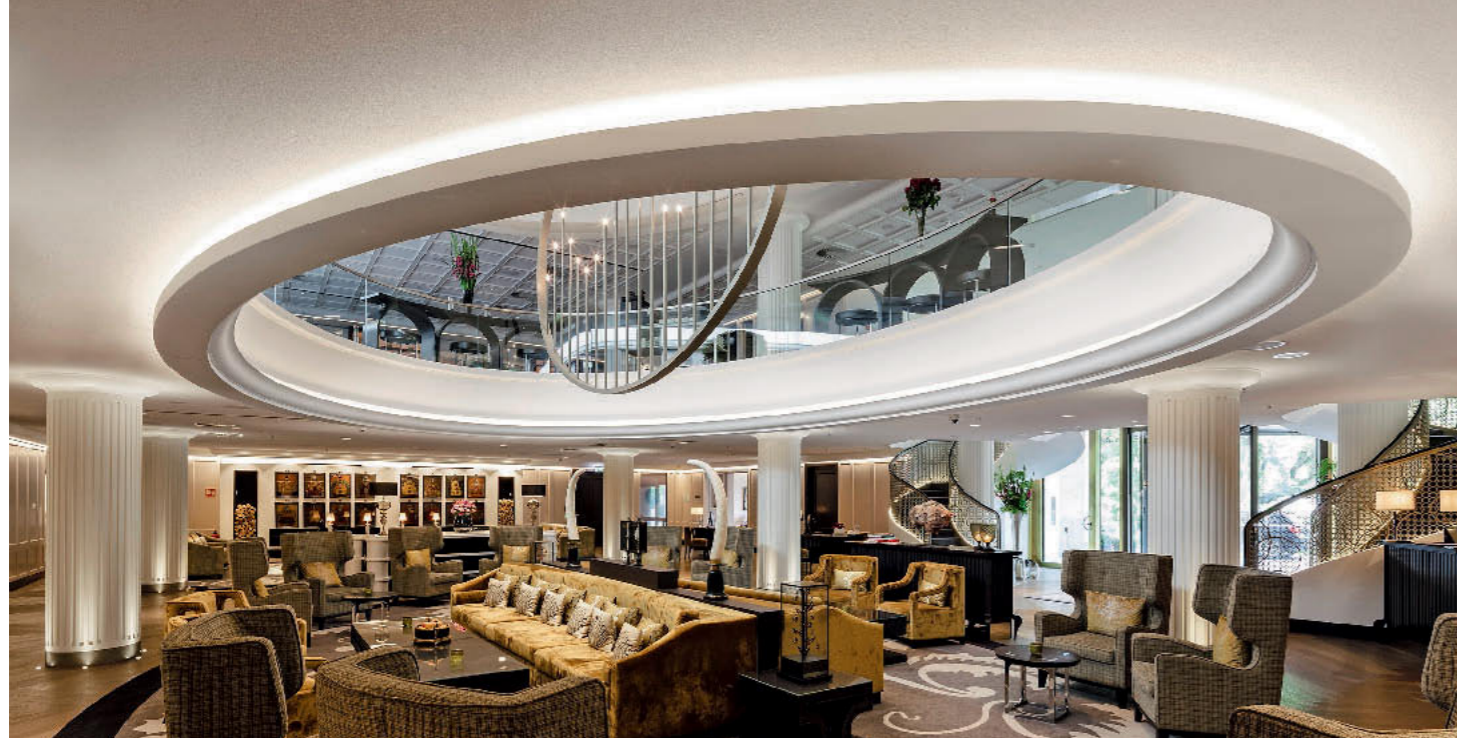
Wer im Empfangsbereich des Hotels Platz nimmt, kann die ruhige Atmosphäre unter einer schallabsorbierenden Akustikputzdecke genießen.
