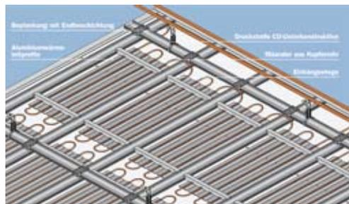
**Variabel.** Das Deckensystem kann als reine Klimadecke installiert werden, ebenso wie als Akustikklimadecke oder Akustikputzklimadecke.
