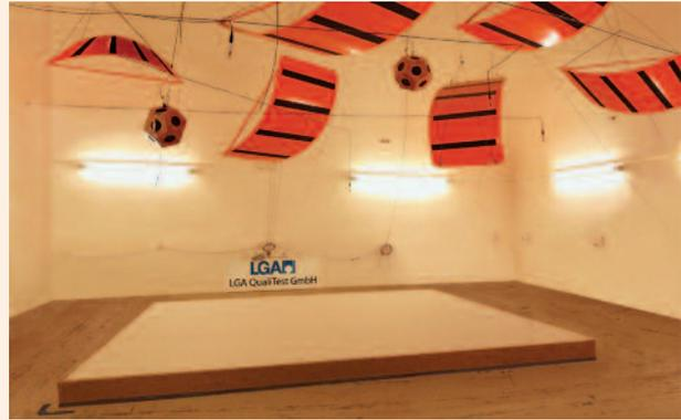
3 Die Schallabsorption wird in einem Hallraum gemessen. Die gekrümmten Metallplatten sorgen für ein diffuses Schallfeld. Wird ein Prüfkörper eingebracht, verändert sich die Nachhallzeit. So kann die Absorption exakt bestimmt werden.
