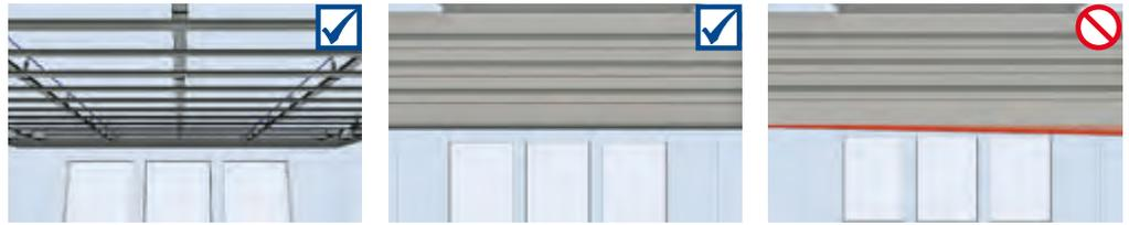
Längsverbinder sind stets versetzt anzubringen (siehe Darstellung) Anschließend CD-Deckenprofile auf ihre Achsabstände kontrollieren und gegebenenfalls nachjustieren Achsabstände korrekt messen!
