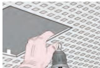
Hierbei gilt: Mindestens 2 Stück Schrauben je Rahmenseite bei Klappengröße < 500 x 500 mm und mindestens 3 Stück je Rahmenseite bei Klappengröße > 500 x 500 mm.
