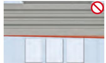
Anschließend CD-Deckenprofile auf ihre Achsabstände kontrollieren und gegebenenfalls nachjustieren. Längsverbinder sind stets versetzt anzubringen (siehe Darstellung). Achsabstände korrekt messen!
