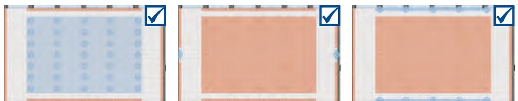
Plattenkennzeichnung (Stempel) beachten und in Leserichtung montieren (alle Stempel zeigen in dieselbe Richtung)
