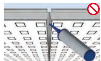
Um eine hohe Festigkeit der GSG4-Fuge zu erreichen, ist unbedingt darauf zu achten, dass der Fugenbereich vollständig ausgefüllt und ausreichend Spachtelmasse verwendet wird
