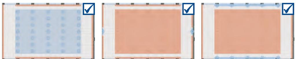
Plattenkennzeichnung (Stempel) beachten und in Leserichtung montieren (alle Stempel zeigen in dieselbe Richtung)
