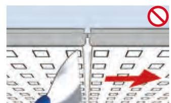
Fugen und Schraubköpfe werden abschließend mit Spachtel- oder Finishmaterial nachgespachtelt, an der Fuge liegende Lochreihen sollten zuvor mit Kreppband abgeklebt werden
