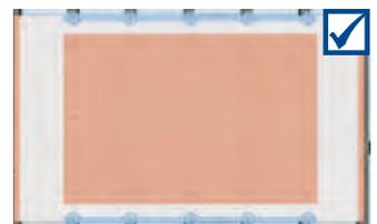
Plattenkennzeichnung (Stempel) beachten und in Leserichtung montieren (alle Stempel zeigen in dieselbe Richtung)
