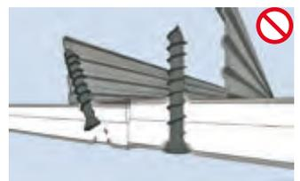
Schraubabstand maximal 170 mm von Befestigungspunkt zu Befestigungspunkt. Maximaler Schraubabstand zur Außenkante der Platte 26 mm. Verletzungen der Akustikdesignplatte durch Schraubensenköpfe sind zu vermeiden
