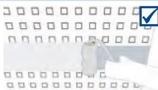
Bei Bedarf die Kleberstruktur auf der Sichtseite des Tapes leicht egalisieren – **nicht schleifen!**
