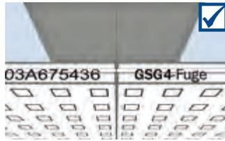
Nächste Deckenplatte Stoß an Stoß zur ersten Platte montieren. **Nur bei beschädigten Stoßkanten** sind Montagehilfen einzusetzen, um das korrekte Fugenmaß einzuhalten
